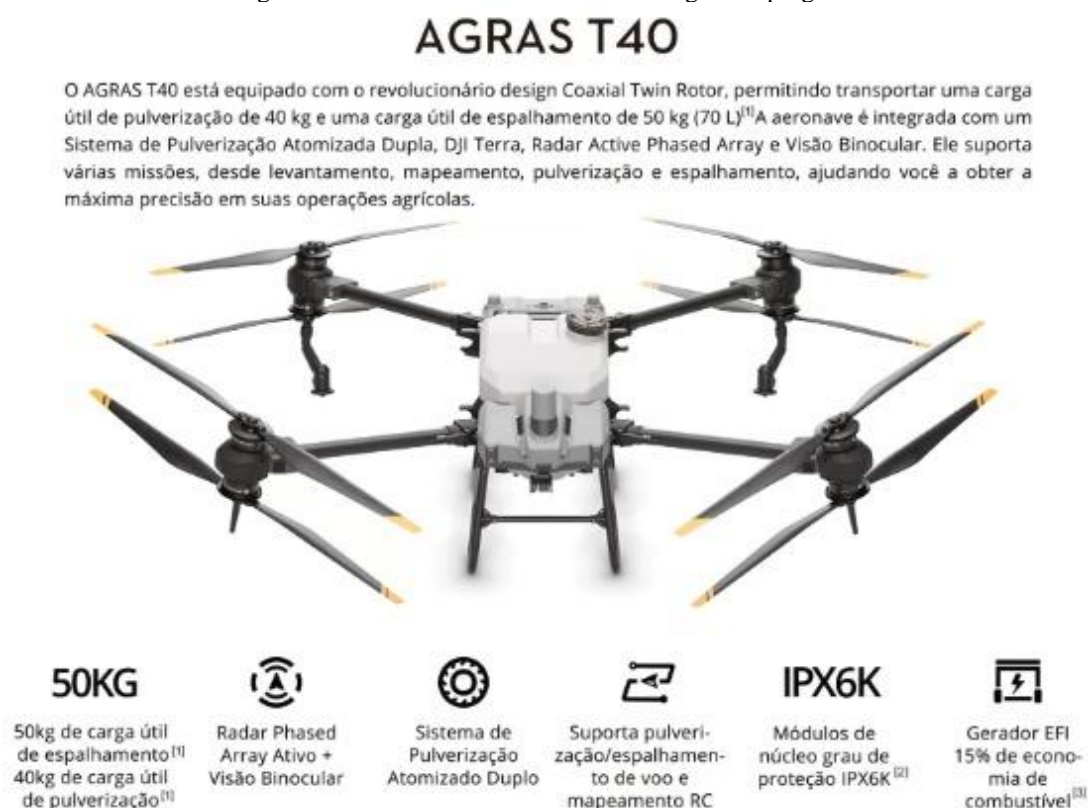
Figura 4 - Modelo de drone e suas tecnologias empregadas
